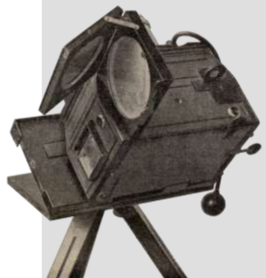
Jumelle stéréo 9 x 12 avec clisimètre
