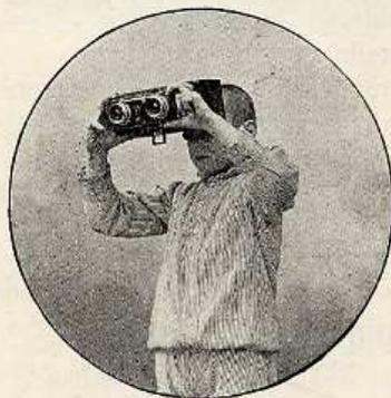
**La détente.** — Il est nécessaire d'effectuer le déclenchement de l'obturateur en deux temps. Ce déclenchement est en effet à double détente. On appuie sur le bouton jusqu'au moment où l'on sent une petite résistance. On attend, dans cette position, le moment favorable, et la moindre pression supplémentaire suffit alors pour opérer le déclenchement. Celui-ci se produit
