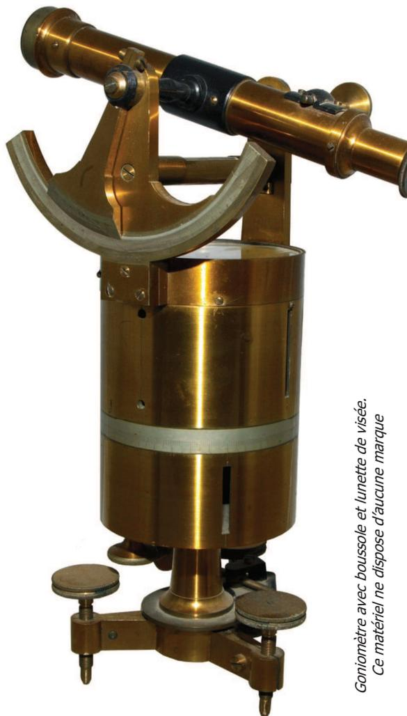
*Goniomètre avec boussole et lunette de visée.
